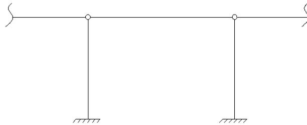
Рис. 4.2 Схема шарнірного кріплення ригелів до колон.
