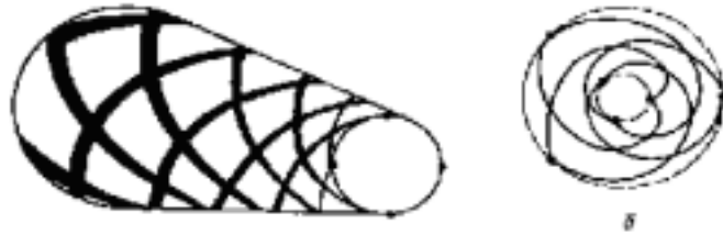
Рис.1.1.6. Еквіугольні спіральні антени з двосторонньою (зустрічною) намоткою: а - конічна чотирезахідна; б - плоска трьозахідна.
