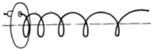
Рис. 1.1.4 Нерегулярне циліндрична спіральна антена (зі змінним кроком)
