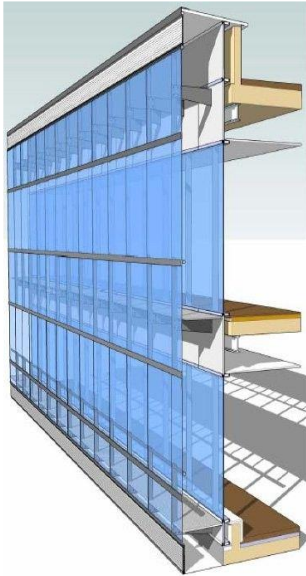
Рис. 2.6 Вузол конструкції фасаду системи «Double Skin»
