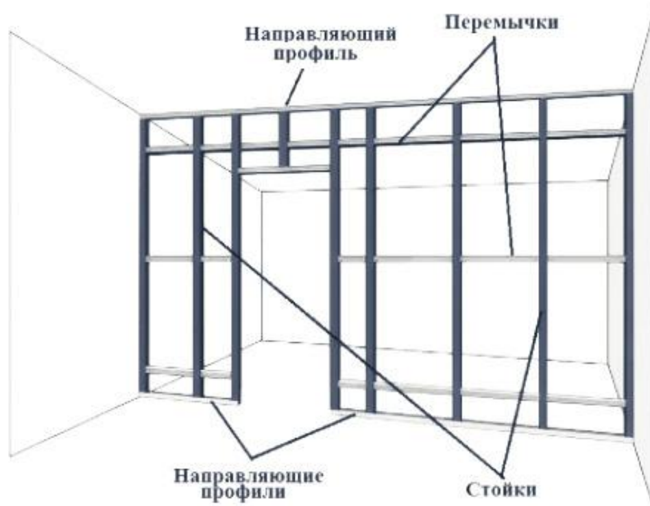
Рис. 3.7. Схема монтажу скляних стін\перегородок
