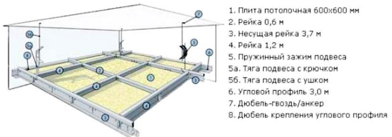
Рис. 3.4. Схема монтажу стелі армстронг
