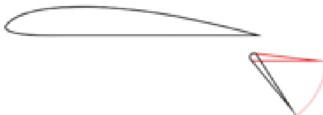
Рис. 1.6. Схема закрилку Юнкерса
