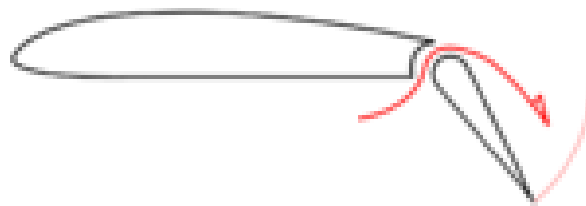
Рис. 1.3. Схема щілевого закрилку
