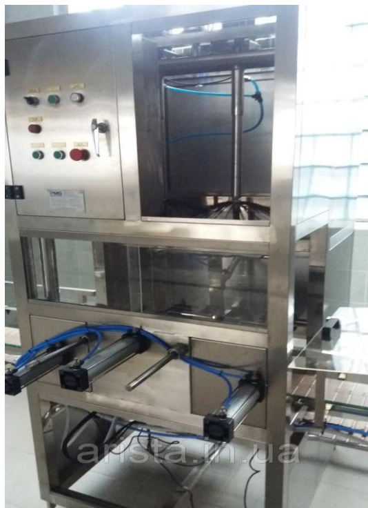
Рис. 3.22. Автомат для внутрішньої мийки бутілен ST-2
