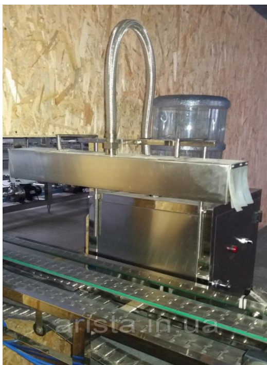
Рис. 3.26. Парова термозбіжна машина ZM-3
