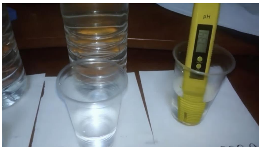
Рис. 4.34. Вимірювання водневого показника, за допомогою рН метра
