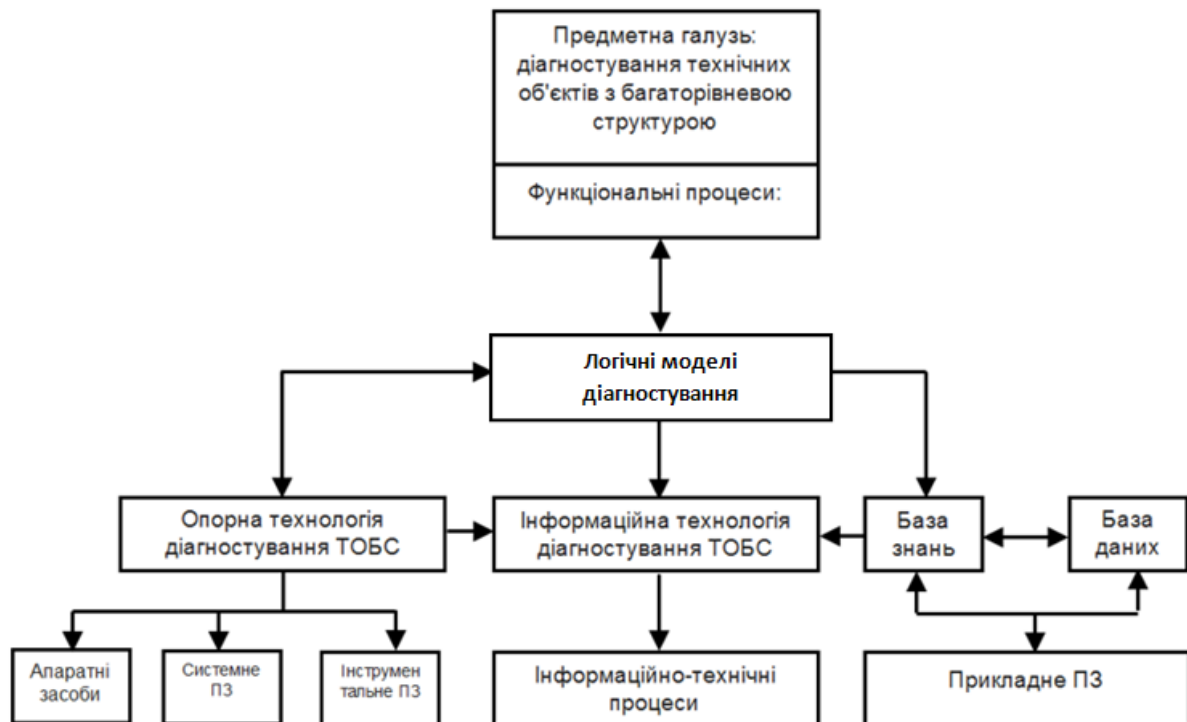
Рисунок 4 – Компоненти інформаційної технології діагностування ТОБС
