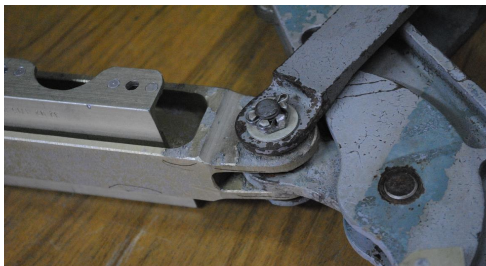
Коррозия тяги механизма внутреннего закрылка 32.02.3715.030.000
