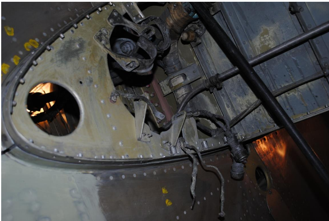
Правая мотогондола - обрывы проводки, коррозия клемм, шарниров
