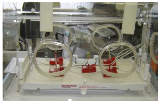
Рис. 1 – Розташування датчиків усередині інкубатора
