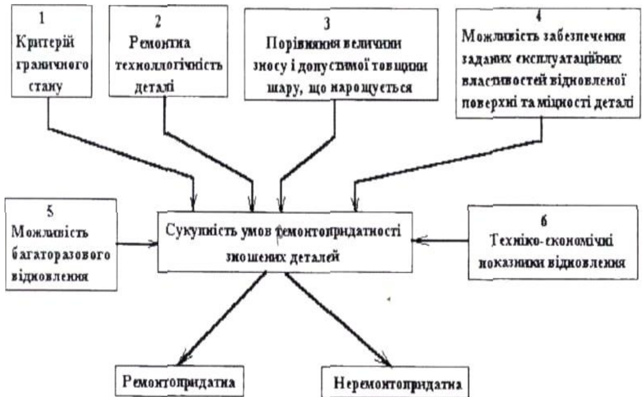
Рис. 3.1. Алгоритм проведення досліджень по оцінці ремонтпридатності деталей, які відновлюються методами нарощування зношених поверхонь
