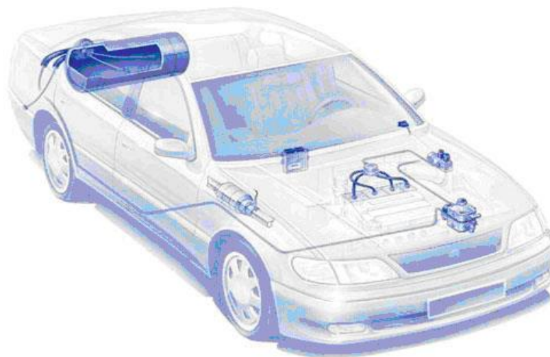
Рис.3.Розміщення елементів ГБО 3-го покоління.
