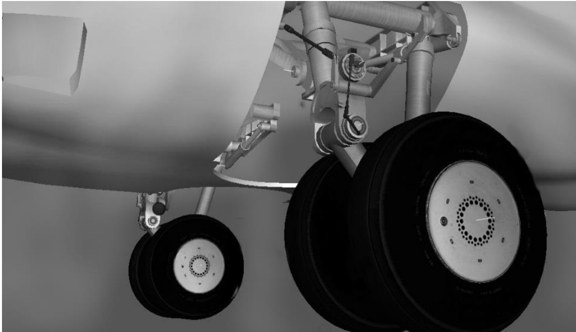
Рис. 1.6. Тривимірний модель основної опори шасі
