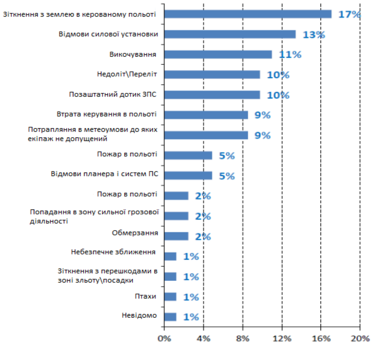
Рис. 1.1.2. Основні типи подій, що призводять до авіаційних випадків з літаками комерційної авіації.
