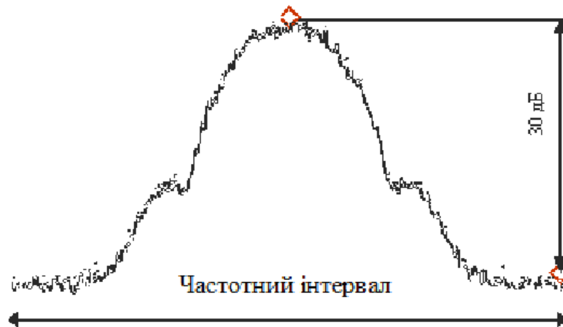
Рис. 5.3. Різниця між піковим рівнем спектра сигналу і рівнем крайніх частот
