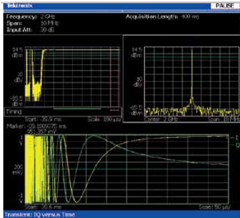
Рис. 6.6. Вимірювання залежності IQ від часу на спаді перехідного процесу
