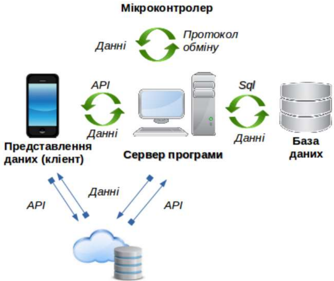
Рис. 3.7 Схеми взаємодії всіх складових системи управління приміщення 2-х поверхового котеджу аграрного призначення, що стоїть окремо з урахуванням технології Інтернет речей
