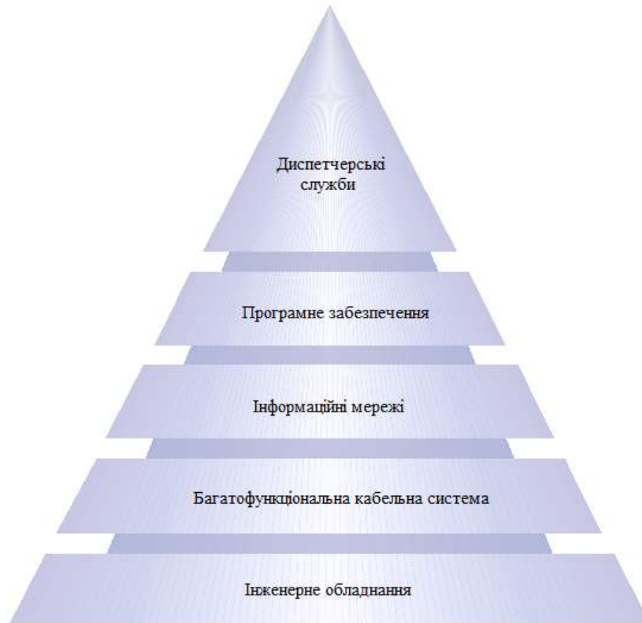
Рис. 3.1 Рівні інтеграції системи управління приміщенням з урахуванням технології Інтернет речей
