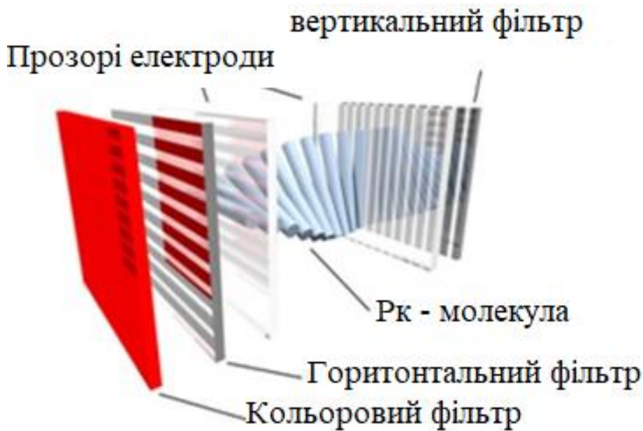
Малюнок 2.4 - Структура субпікселя LCD-дисплея с TN-матрицею
