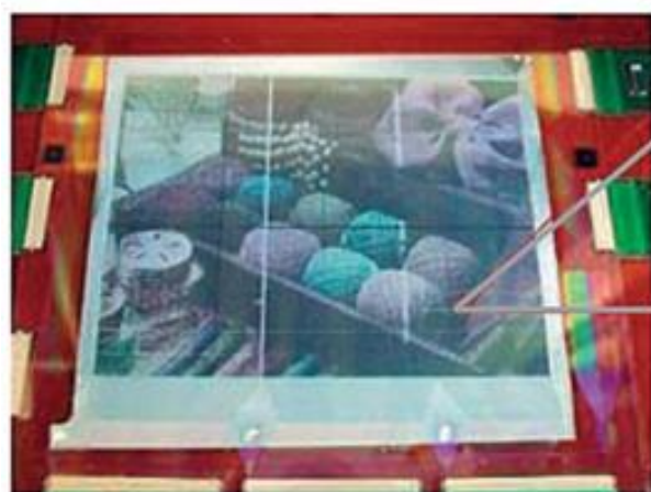
4 - дюймова гнучка кольорова електронна бумага на основі технології фірми E Ink
