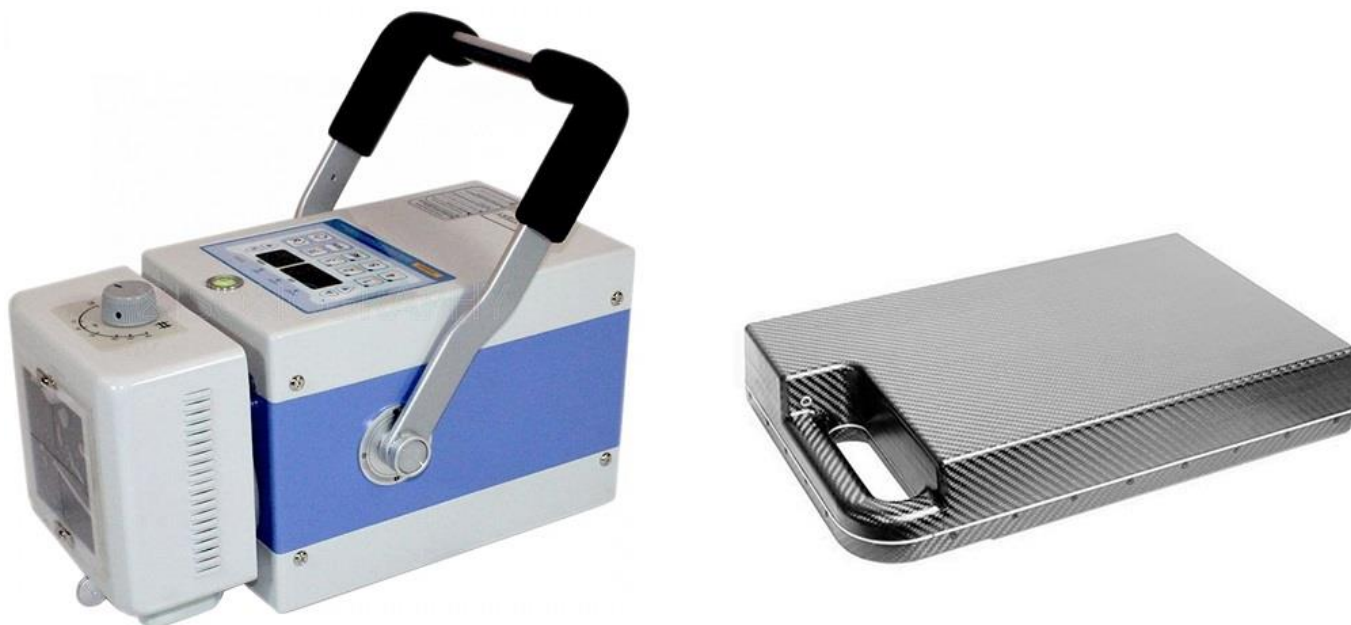
Рис. 3.4. Рентгенівський генератор Poskom PXM-20 BT (зліва) та цифровий рентгенівський приймач Iona2-RF-2430 (справа).
