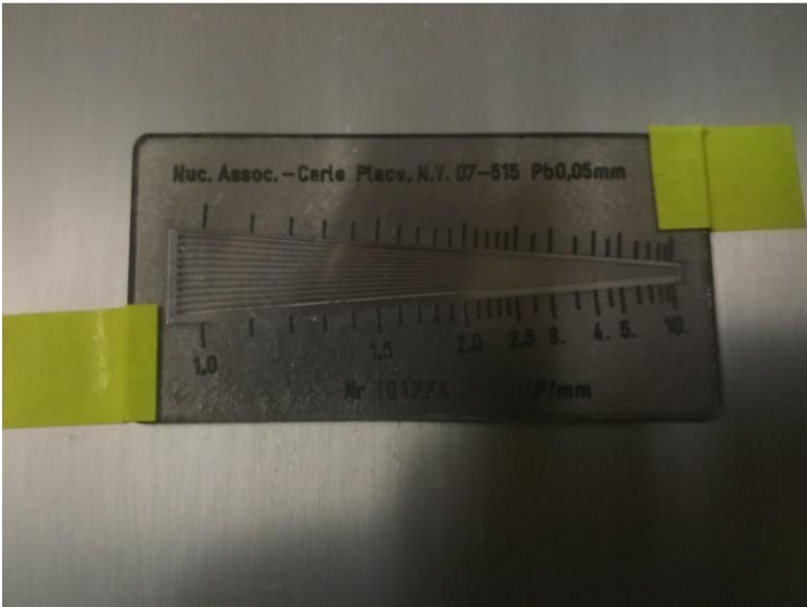
Рис. 3.7. Рентгенівська міра, закріплена на фільтрі (лист алюмінію Al товщиною 4 мм), та встановлена перед вхідним вікном приймача.
