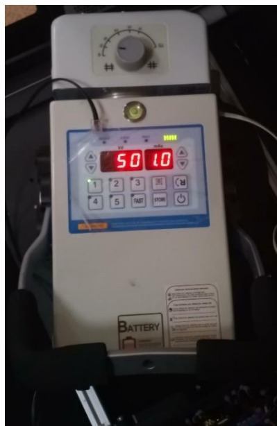
Рис. 3.8. Рентгенівський випромінювач налаштований на різні параметри експозиції (зліва – режим прогріву 50 кВ 1 мАс; справа – робочий режим 81 кВ 50 мАс).
