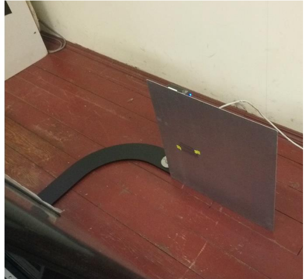
Рис. 3.7. Рентгенівська міра, закріплена на фільтрі (лист алюмінію Al товщиною 4 мм), та встановлена перед вхідним вікном приймача.
