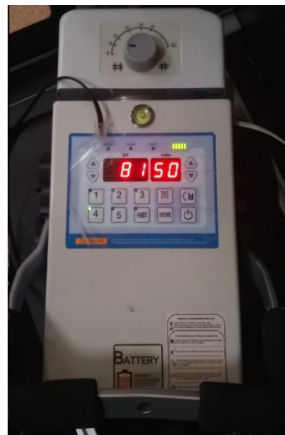
Рис. 3.8. Рентгенівський випромінювач налаштований на різні параметри експозиції (зліва – режим прогріву 50 кВ 1 мАс; справа – робочий режим 81 кВ 50 мАс).
