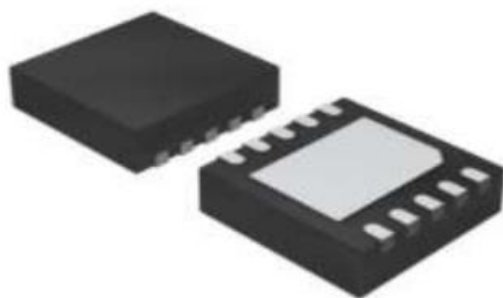
Рис. 2.6.1 - Зовнішній вид мікросхеми NCP1835
