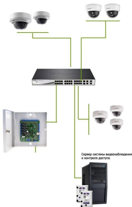
Рис 3.5. Приклад підключення відеонагляду.
