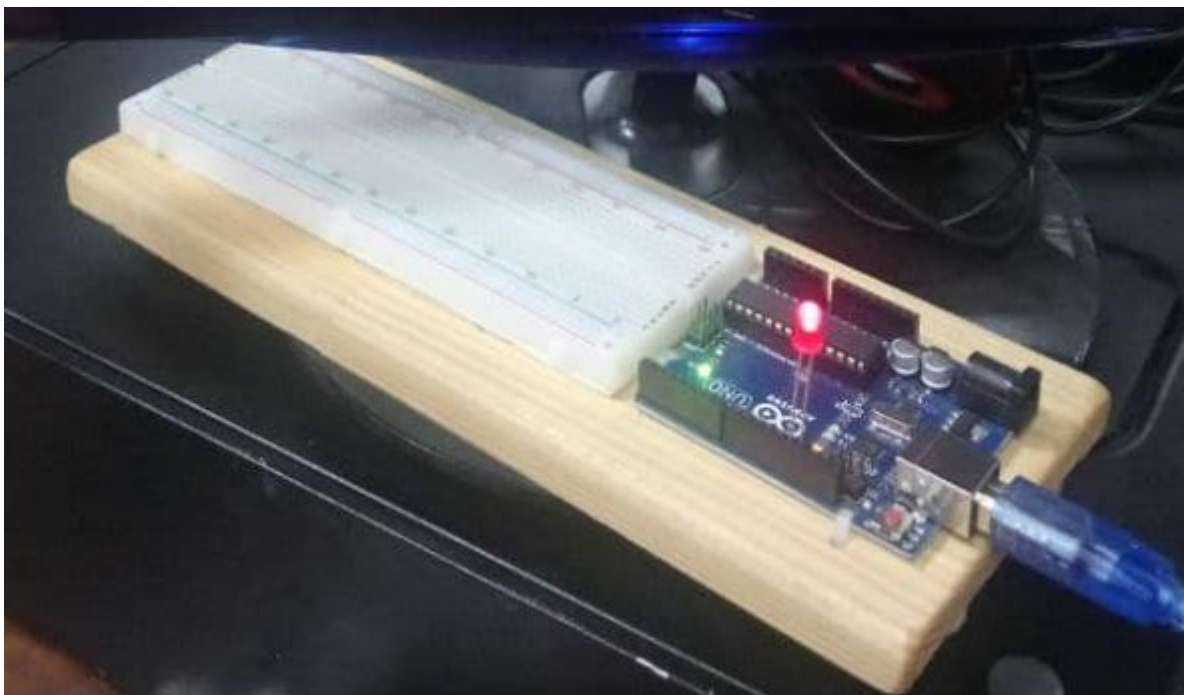
Рис. 17 Модуль Arduino підключений до ПК
