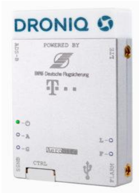
Рис 1.11. Транспондер відстеження Hook-On-Device
