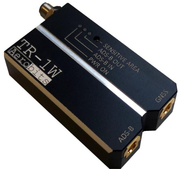
Рис 1.10. 2TR-1W - малопотужний трансивер ADS-B
