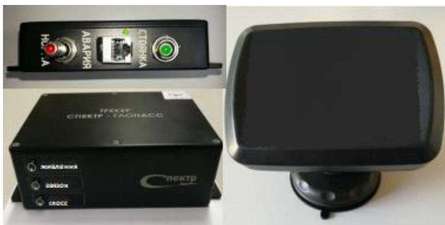
Рисунок 1.6. Бортовий малогабаритний супутниковий трекер БМСТ «СпектрГЛОНАС»
