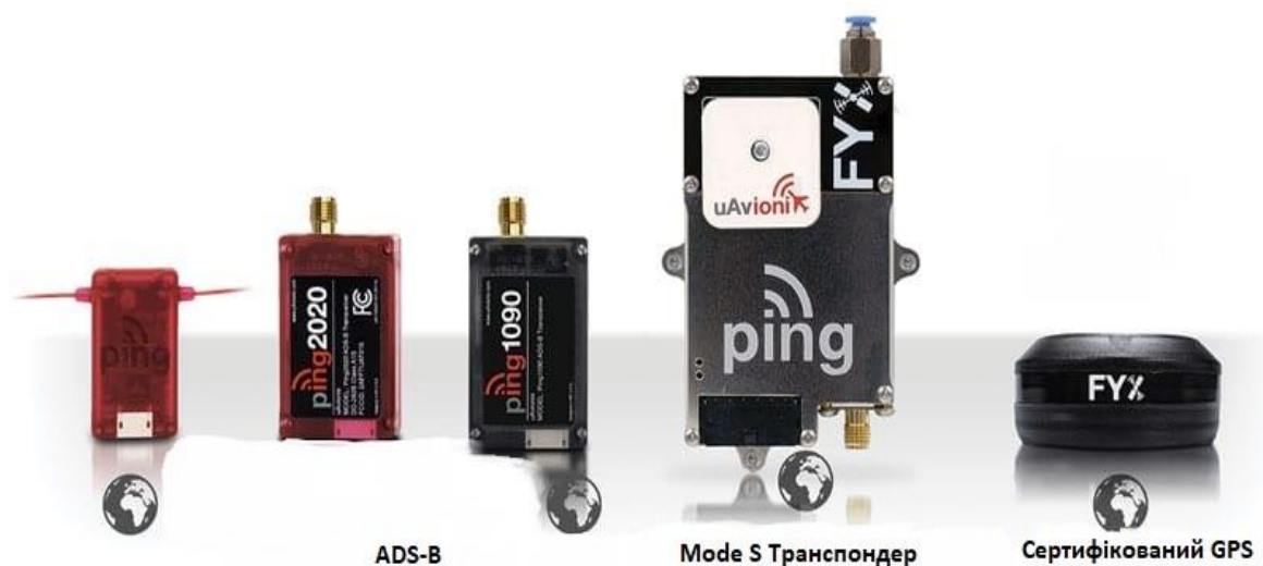
Рисунок 1.5. Транспондери, приймачі, трансивери ADS-B для БЛА
