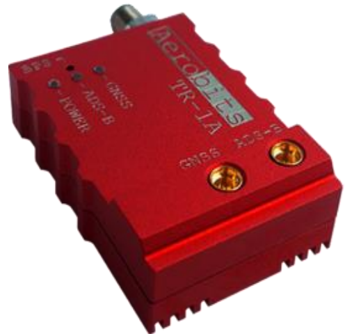
Рис 1.8. Трансивер ADS-B TR-1A
