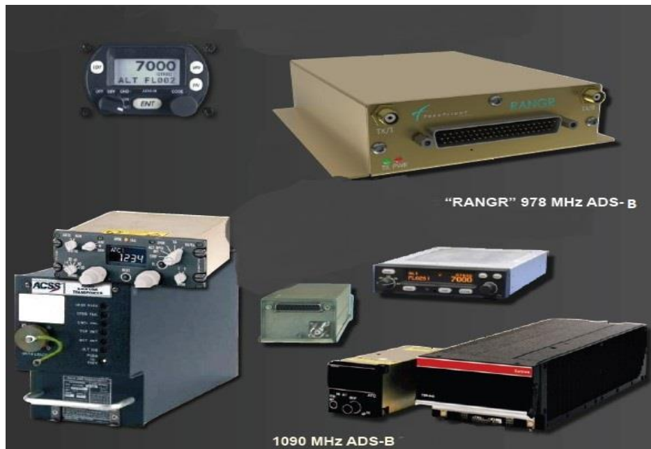
Рисунок 1.2. ADS-B Out обладнання
