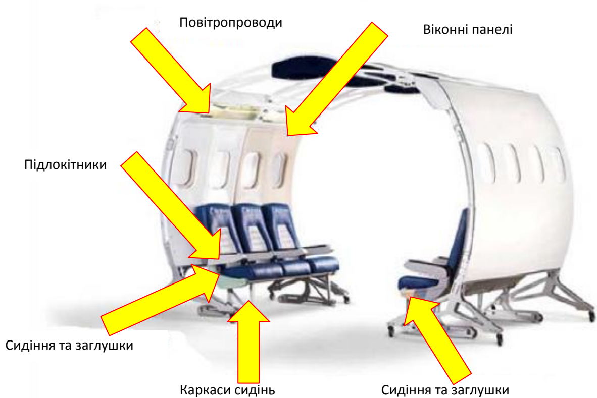
Рисунок 1.7 - Застосування 3D-друкованих деталей у літаках
