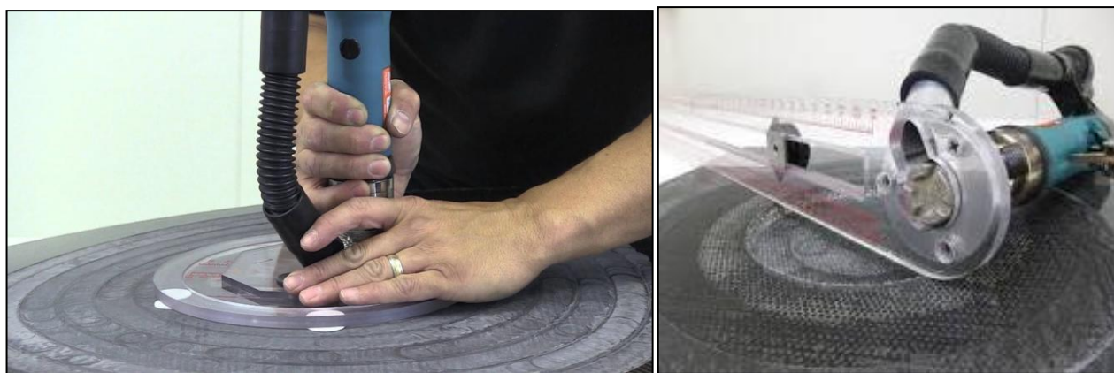
Рисунок 4.10 – Приклади пошарового видалення ушкоджених шарів
