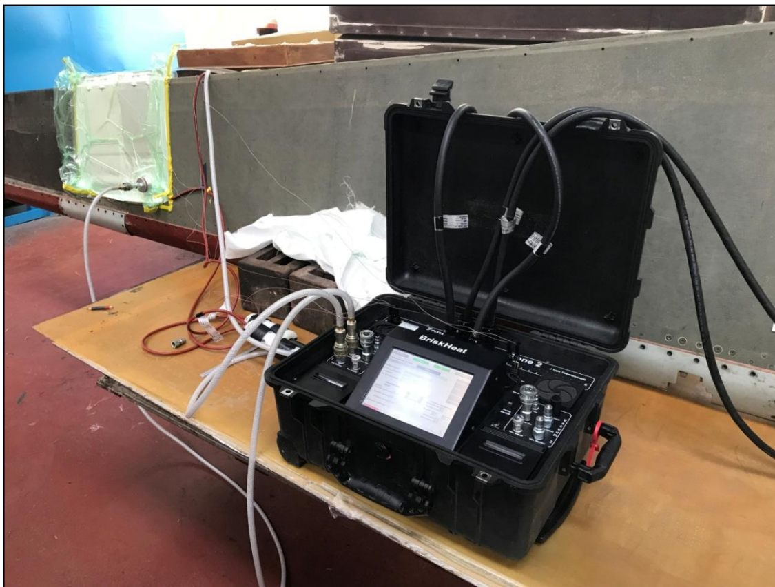
Рисунок 4.12 - Ремонт ушкодженої зони керма висоти літака Ан-178 із застосуванням АРК
