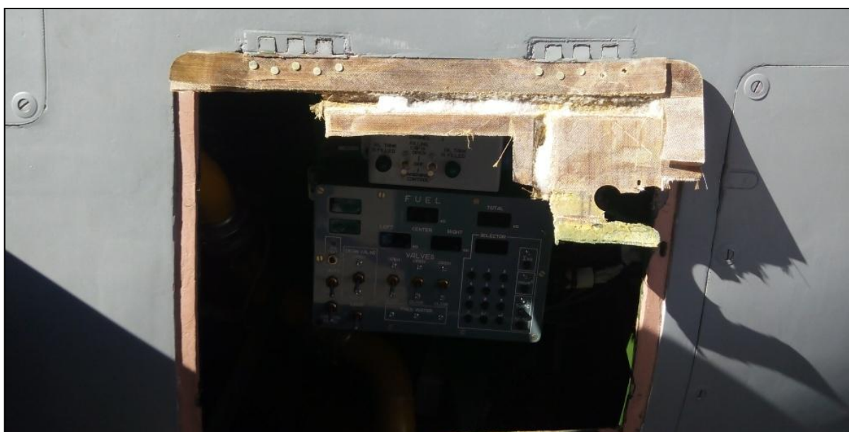
Рис. 4.8 - Вири́в люка переднього лівого обтічника шасі пульту управління заправки паливом на літаку Ан-178
