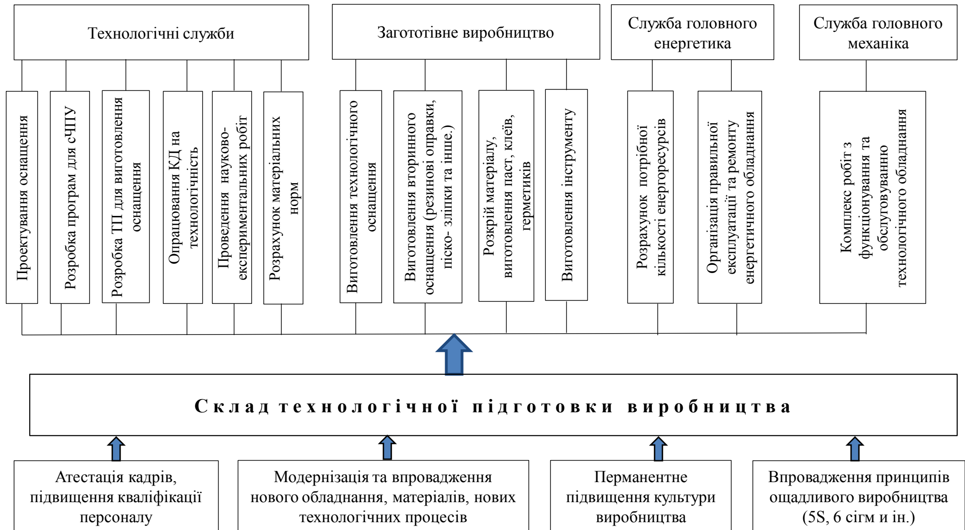
Рисунок 3.1 – Схема інтегральної структури технологічної підготовки виробництва авіаційних конструкцій із ПКМ
