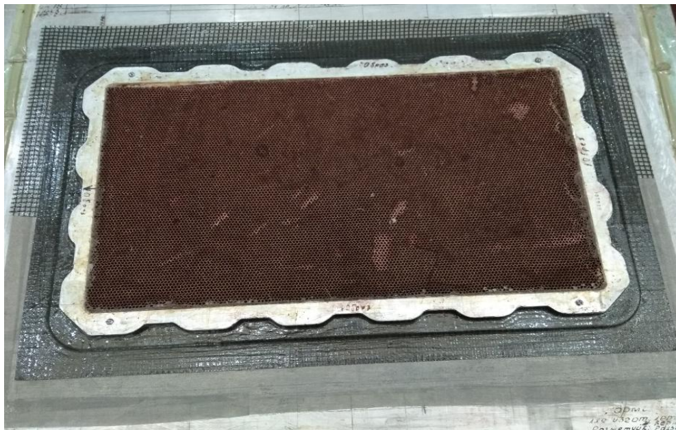
Рисунок 3.22 - Викладення регулярних шарів обшивки поверх раніше отформованої окантовки під люковий отвір
