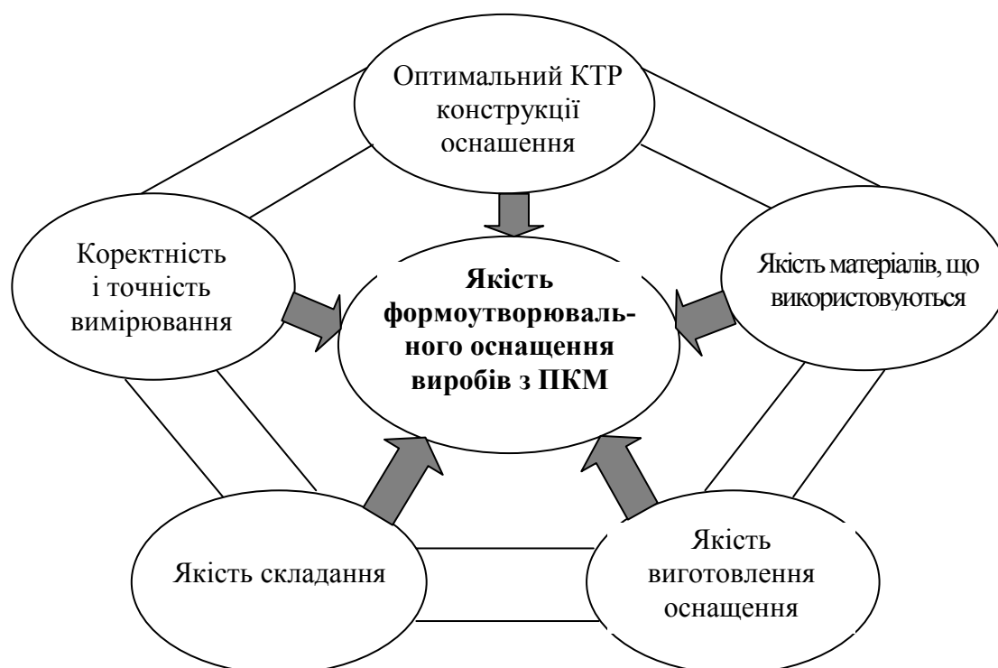
Рисунок 3.2 - Основні складові якості формоутворювального оснащення
