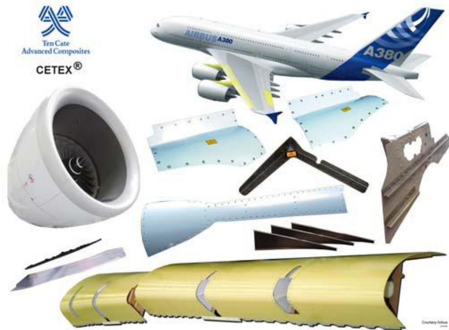
Рисунок 1.5 – Використання композитів з PPS сполучним у літаку Airbus A380
