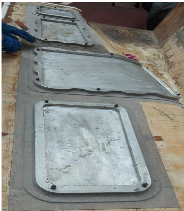
Рисунок 3.17 - Викладення вирівнюючої поверхневої плівки SynSkin в зонах підсікань під установку лючків
