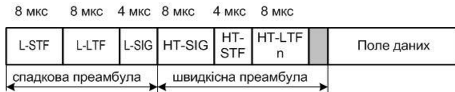
Рисунок 3.13 – Структура преамбули кадру фізичного рівня згідно зі специфікацією IEEE 802.11n у змішаному режимі
