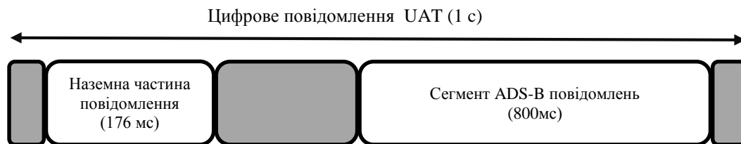
Рис. 1.13. Будова цифрового повідомлення за UAT
