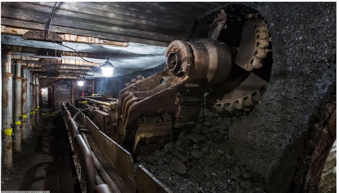
Рис. 3.1.1 Очисний комбайн 1К101У.
