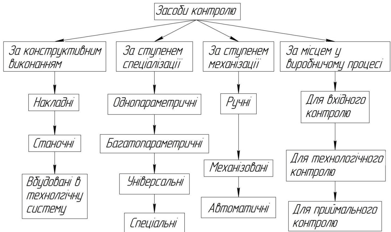
Рис. 1.1 Класифікація засобів вимірювання зубчастих коліс
