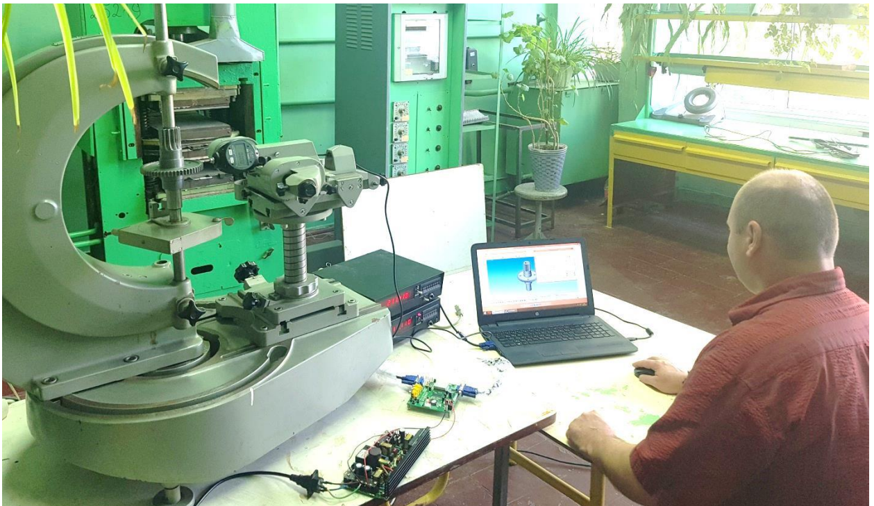
Рис. 4.2 Експериментальна приладова система для вимірювання зубчастих коліс
