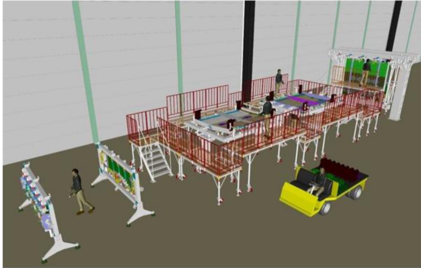
Рисунок 9 - Лінія крупновузлового складання центроплана літака Ан-148, розроблена в системі віртуальної реальності. Загальний вигляд
