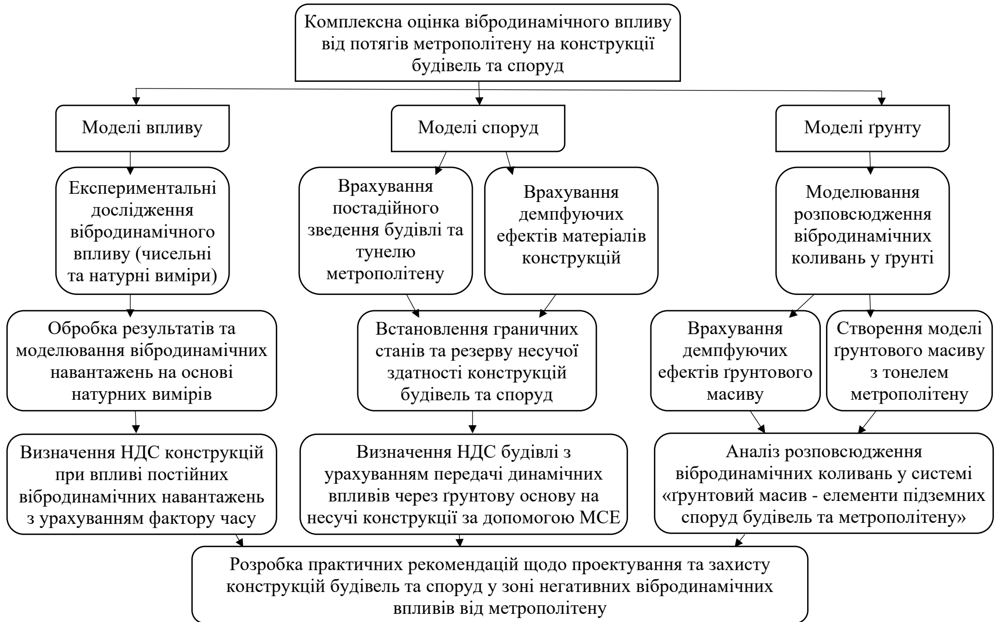
Рис. 3.26. Алгоритм оцінки вібродинамічного впливу від метрополітену на несучі конструкції будівель та споруд
