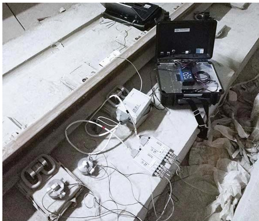
Рис. 4.6. Вимірювання вібрації у тунелі метрополітену
