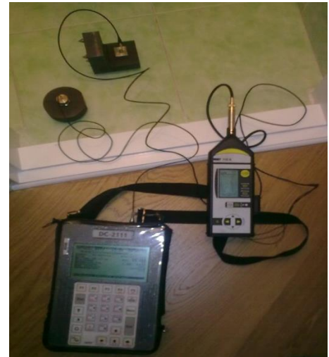
Рис. 4.3. Вимірювання вібрації на підлозі квартири
