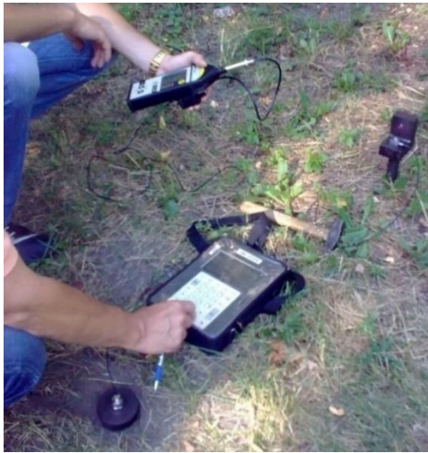
Рис. 4.2. Вимірювання вібрації на поверхні ґрунту
