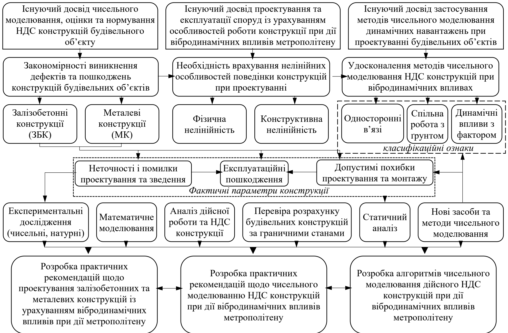
Рис. 1.2. Методологічна схема вирішення наукової задачі вібродинамічного впливу від руху потягів метрополітену
