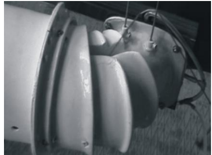
Рис. 4.8. Багатокаскадна камера змішування ежектора
