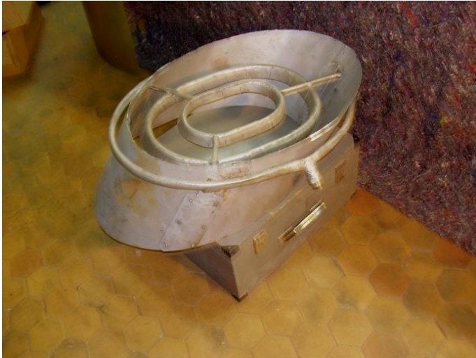
Рис. 5.7. Натурний зразок ежектора з комплексним видуванням активного та пасивного газів у камеру змішування
