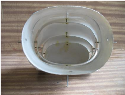
Рис. 4.8. Багатокаскадна камера змішування ежектора
