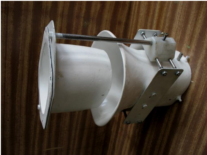
Рис. 1.2. Загальний вигляд експериментального зразка газового ежектора
