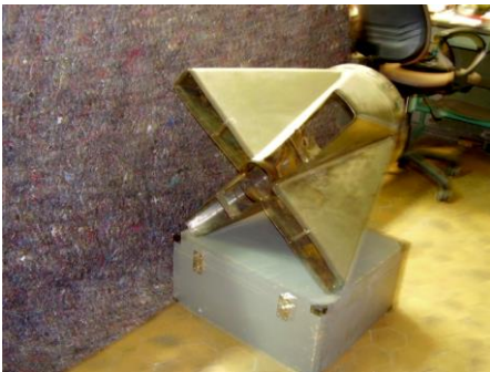
Рис. 5.6. Натурний зразок ежектора з багатосекційним соплом активного газу
