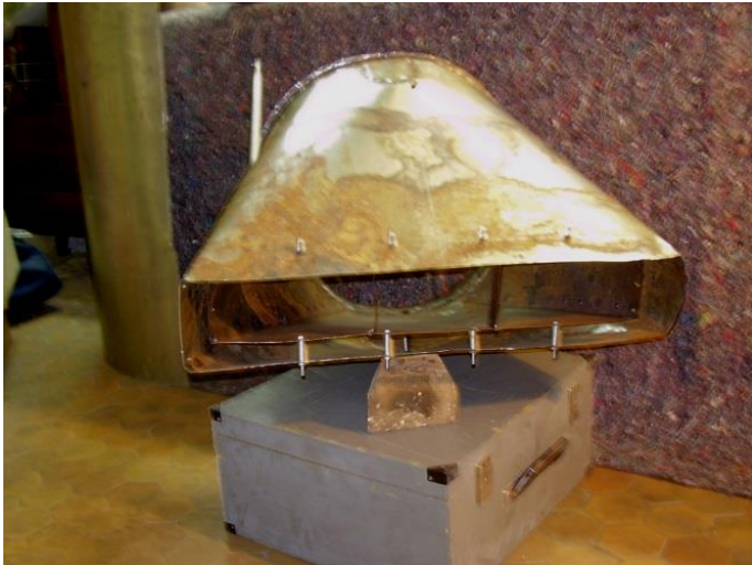
Рис. 5.8. Натурний зразок ежектора з переходом форми камери змішування із циліндричної в плоску
