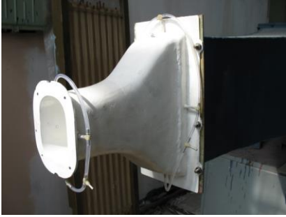
Рис. 4.7. Сопло активного газу із поворотом потоку на 90°
