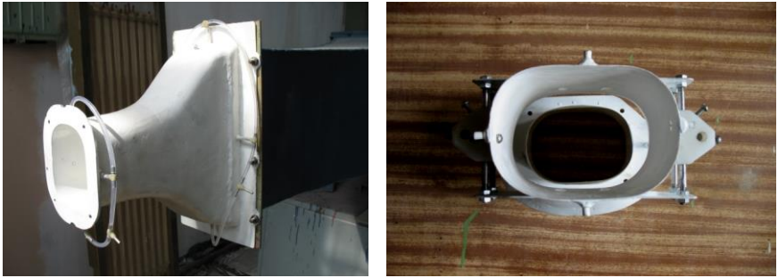
Рис. 4.5. Експериментальний модельний сопловий насадок та модельний осьовий дозвуків ежектор
