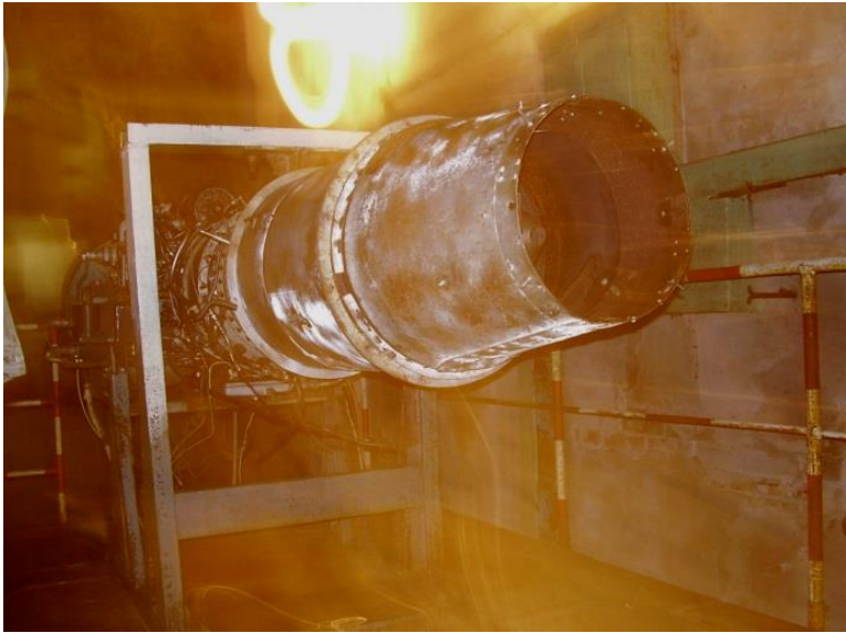
Рис. 5.10. Натурний зразок осевого газового ежектора із регульованою камерою змішування
