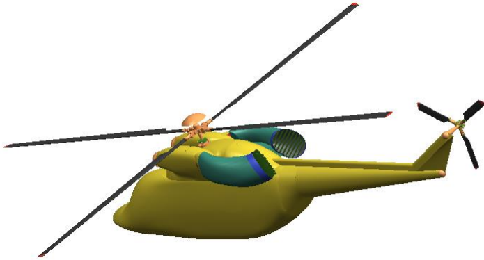
Рис. 4.11. Вертоліт із вихлопним пристроєм, що повертає потік викидних газів вгору
