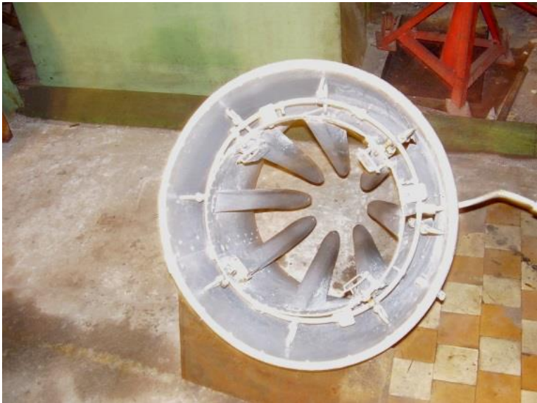
Рис. 4.10. Дослідний зразок ежектора з пелюстками на вході до камери змішування для ЕВП
