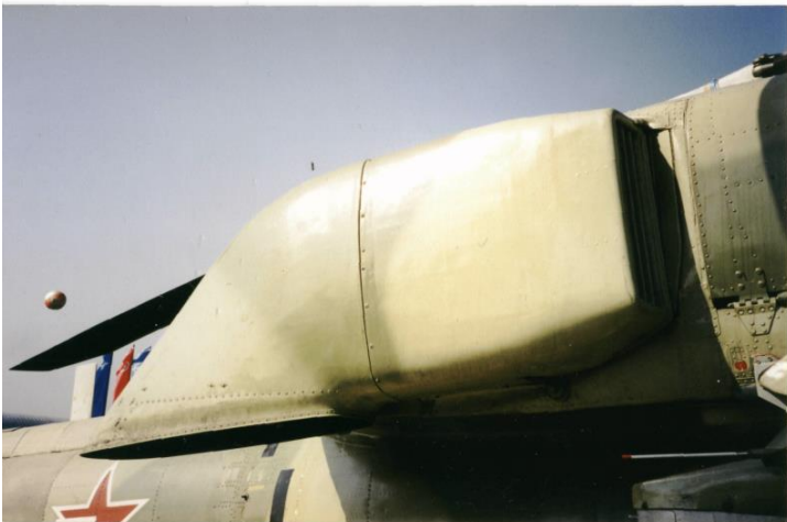
Рис. 5.1. Екранно-вихлопний пристрій вертолітного ГТД
