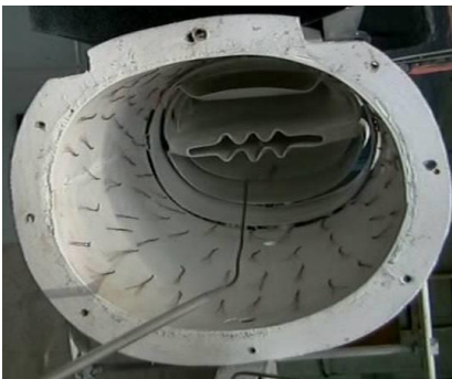
Рис. 4.8. Багатокаскадна камера змішування ежектора
