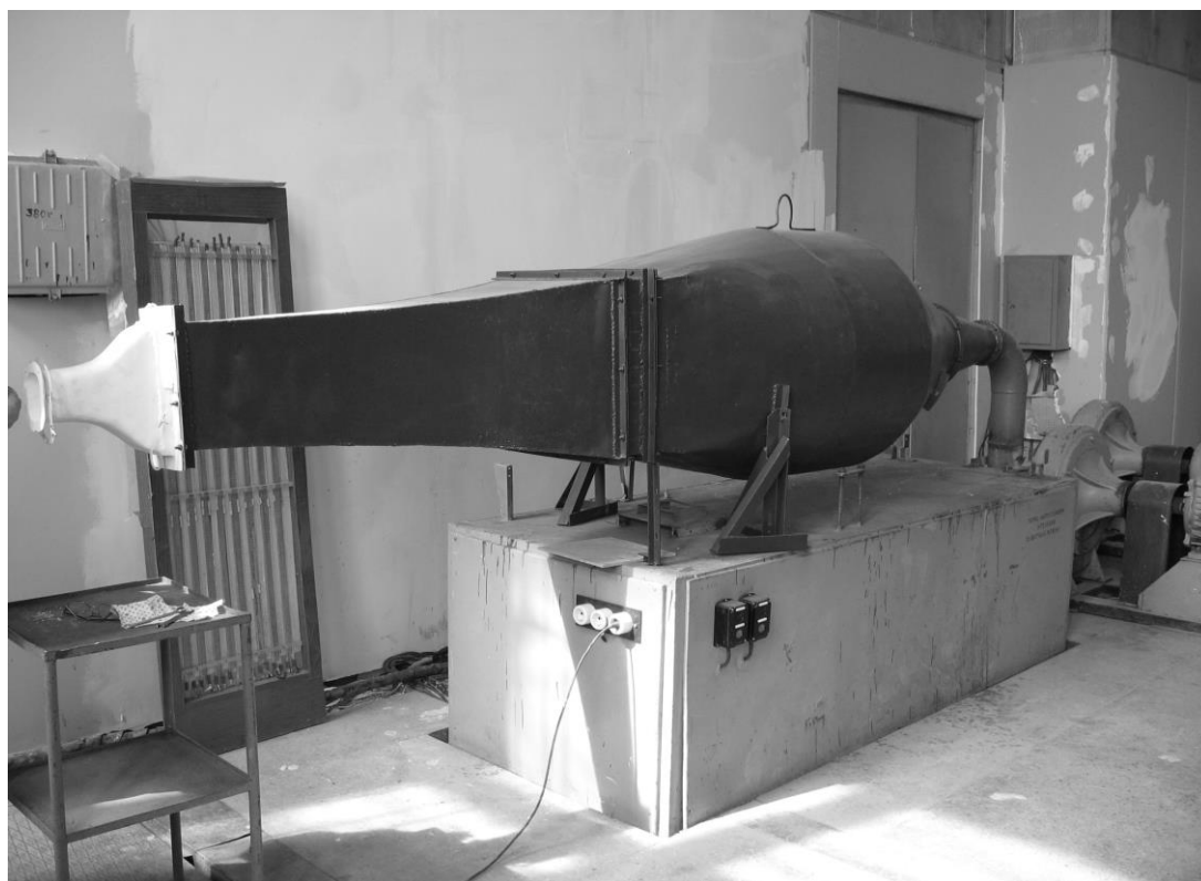
Рис.3. Експериментальна установка для дослідження особливостей течії газу в екранно-вихлопних пристроях
