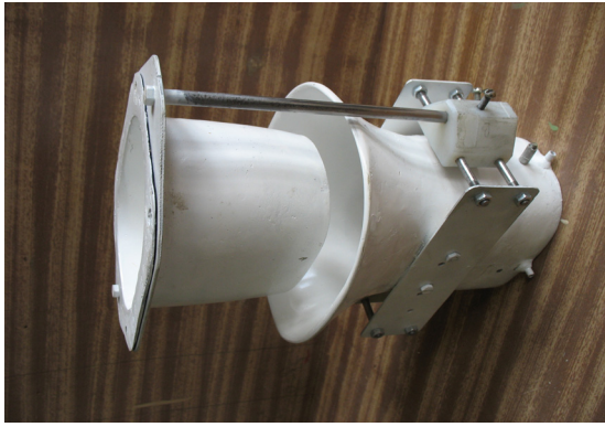
Рис.1. Загальний вигляд осьового дозвукового газового ежектора
