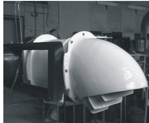
Рис.3. Загальний вигляд осьового дозвукового газового ежектора з ежектуванням через сопло першого контуру
