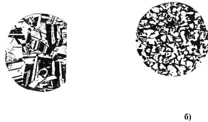
Мал.3. Мікроструктура деформованої і відпаленої латуні Х200: а) \alpha - латуні, б) \beta -латуні.
