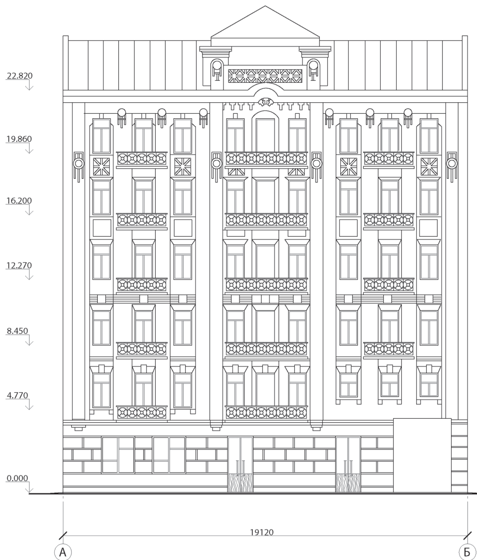
Рисунок 12. Проектное решение устройства новых балконов по оси здания на три световых проёма в стене, 1975 г. [21]
