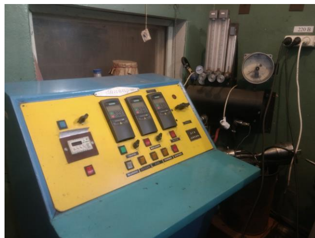
Рис. 2.6. Детонаційна установка „Днепр-3” з пультом керування.
