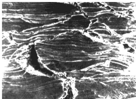
Рис. 3.14. Поверхня тертя покриття Cr-Si-B ілюструєфрагмент руйнування при температурі 700 °C (x320).
