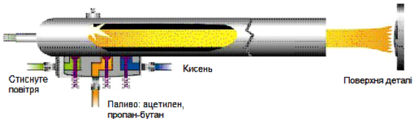
Рис. 2.5. Принцип формування детонаційних покриттів.
