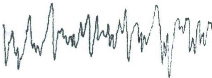
Рис. 3.7. Профілограма поверхні тертя покриття на основі Cr-Si-V при 8 МПа; \text{V}3 \times 1000 ; \text{Г}3 \times 40 .
