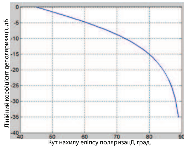
Рис. Б.3 Залежність лінійного коефіцієнту деполаризації від кута нахилу еліпсу поляризації прийнятого сигналу
