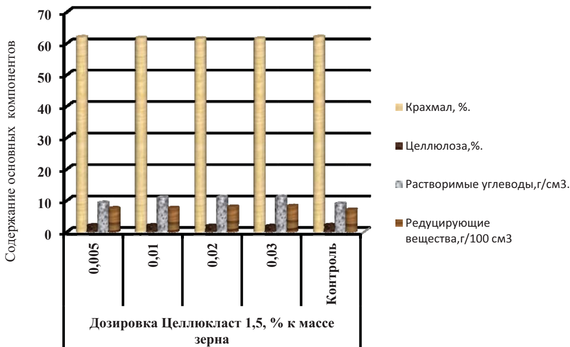
Рис.2-Влияние дозировки ферментного препарата Целлюкласта 1,5L на содержание некоторых компонентов водно-мучнистой суспензии
