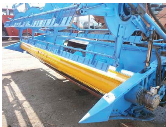
Рис.1. Жатки для уборки зерновых методом «очеса»: 1. Универсальная жатка (заявка на изобретение № 2014106512); 2. Зерноуборочный агрегат (заявка на изобретение № 2014100495); 3. Опытный образец жатки для уборки методом «очеса» опытом конструкции Самарской сельхозакадемии.
