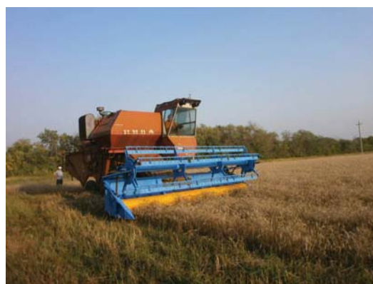
Рис.1. Жатки для уборки зерновых методом «очеса»: 1. Универсальная жатка (заявка на изобретение № 2014106512); 2. Зерноуборочный агрегат (заявка на изобретение № 2014100495); 3. Опытный образец жатки для уборки методом «очеса» опытом конструкции Самарской сельхозакадемии.
