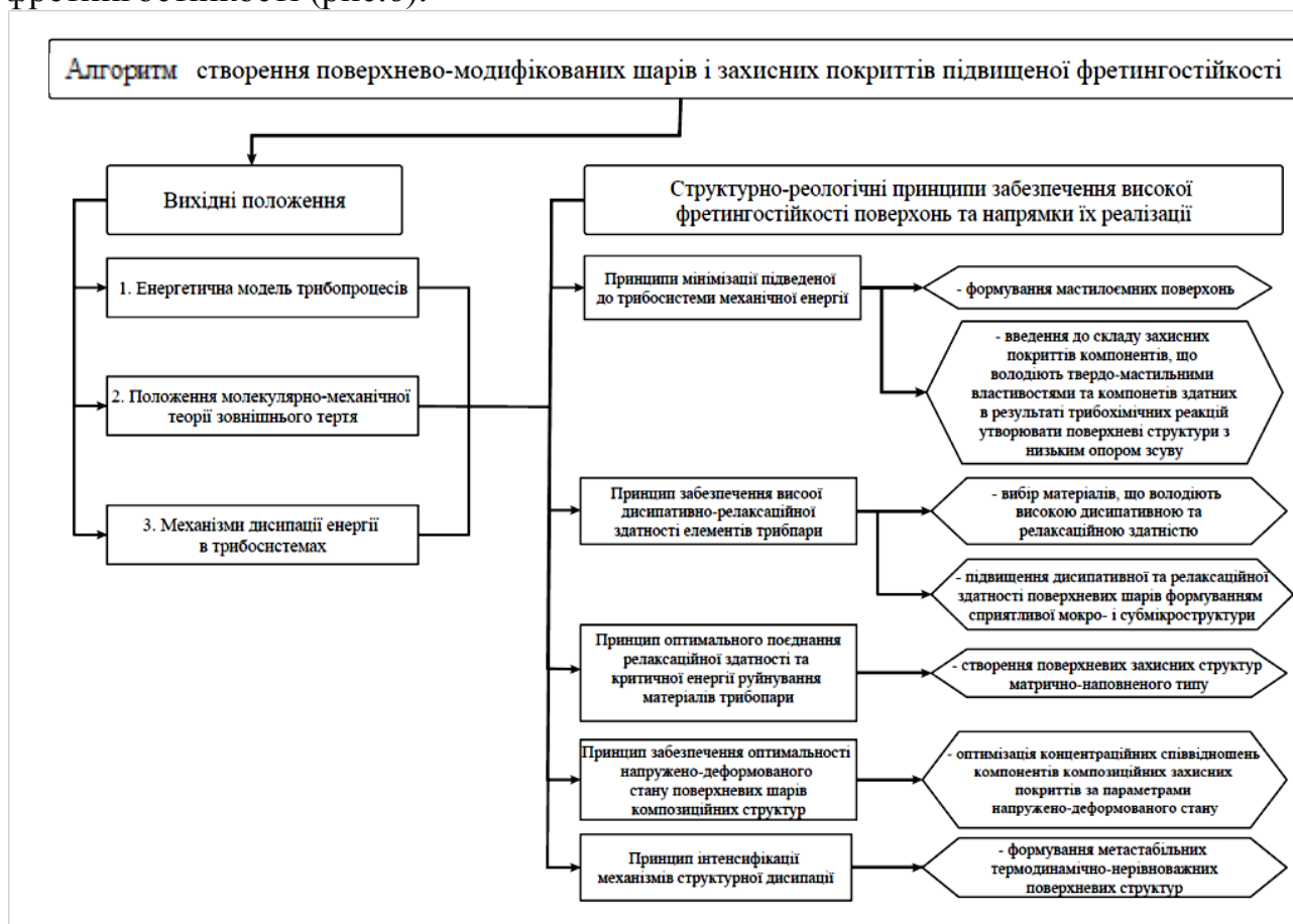
Рис. 6 Алгоритм створення поверхнево-модифікованих шарів і захисних покриттів підвищеної фретингостійкості
