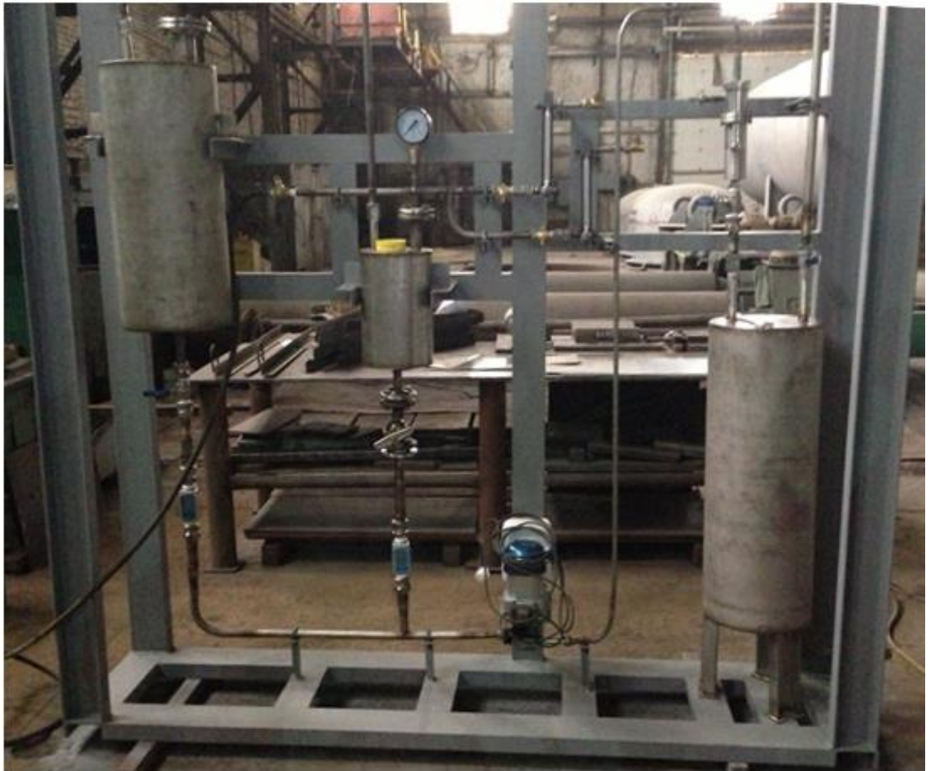
Рис. 4.6. фотографія установки для кавітаційної переробки моторних палив
