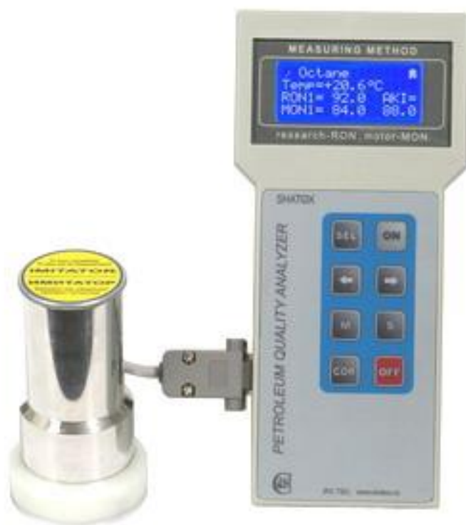
Рис. 2.1. Зовнішній вигляд октанометру SHATOXSX-150
