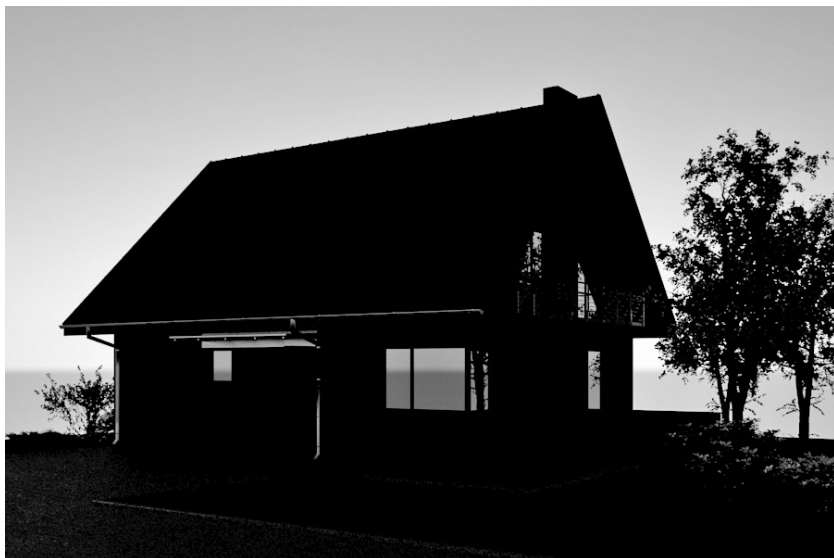
Рис. 2.57. Шейдер окружения mr Physical Sky предоставляет визуализацию солнечного диска и неба, помимо этого, он воздействует на отражения и преломления в материалах объектов сцены
