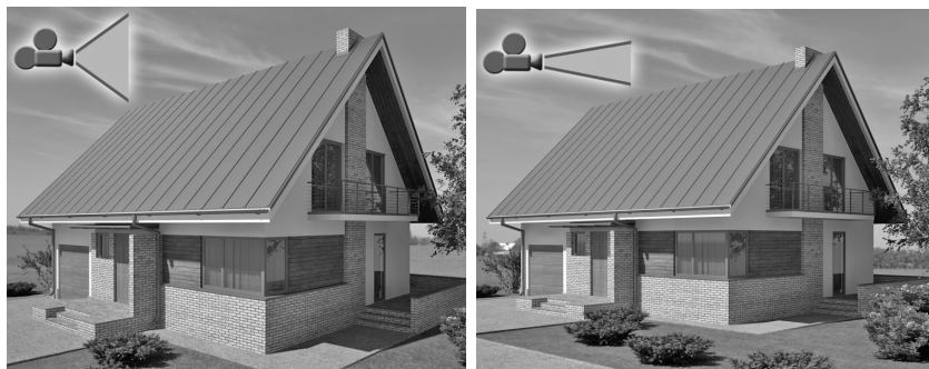
Рис. 2.8. Короткое фокусное расстояние, широкое поле обзора (слева); длинное фокусное расстояние, узкое поле обзора (справа)
