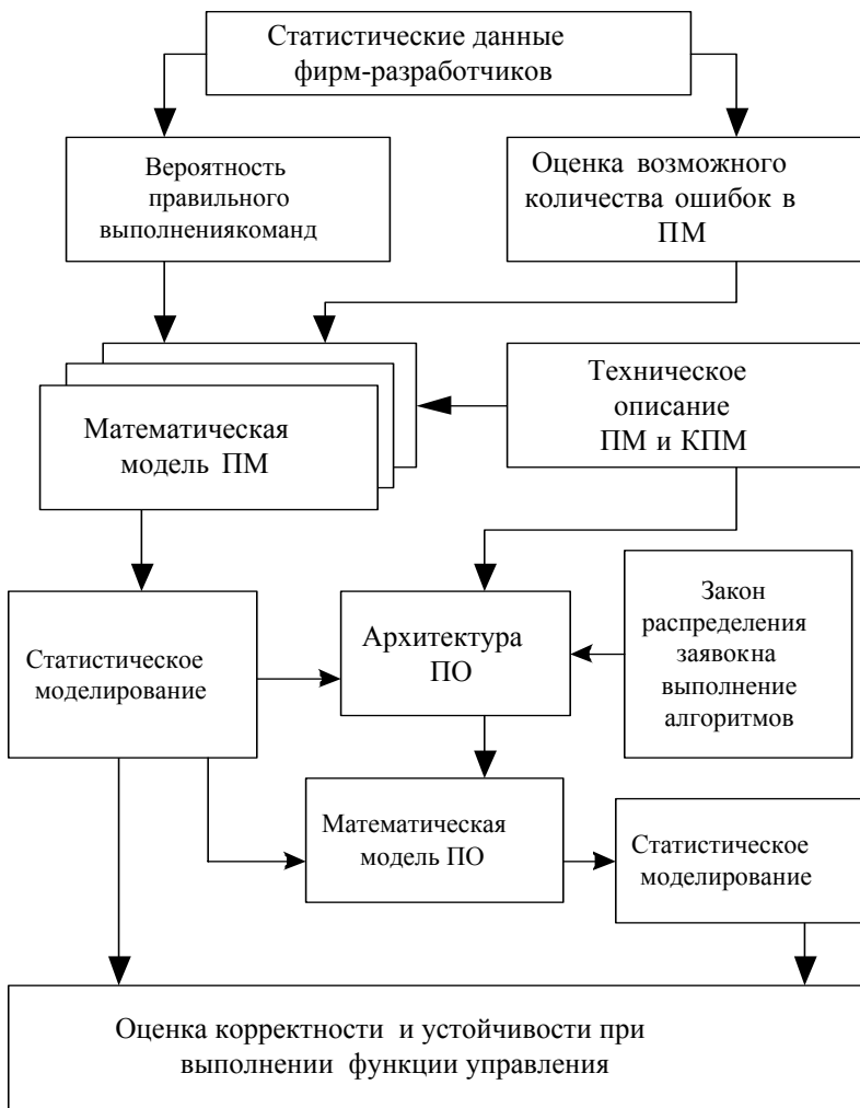
Рис.5.3. Общая схема оценки надежности программного комплекса
