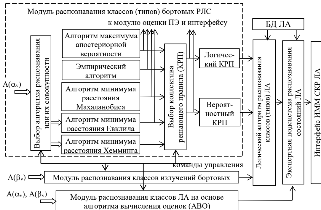
Рис. 2 – Структурная схема блока модулей распознавания ИММ СКР
