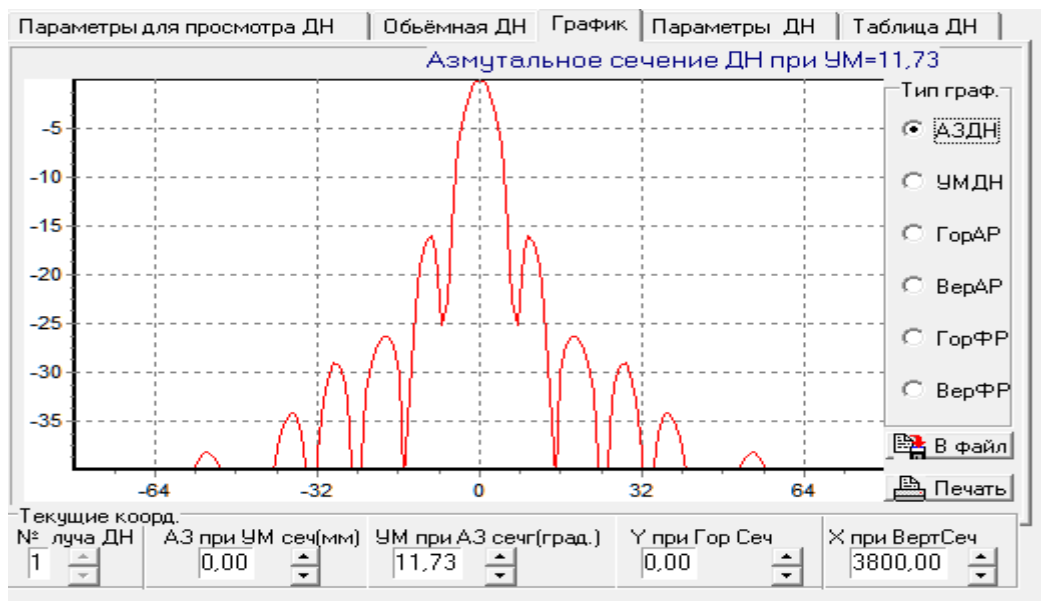
Рисунок 1 Диаграмма направленности антенной системы в азимутальной плоскости
