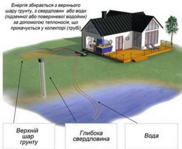
Рис. 4.19. Принцип дії опалення геотермальним тепловим насосом
