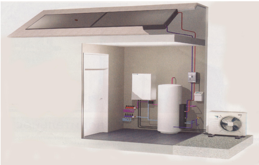
Рис. 4.23. Оптимальне розміщення обладнання теплового насоса
