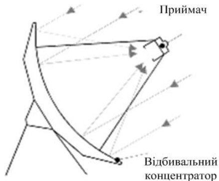
Рис. 3.5. Структурна схема СЕС тарілкового типу
