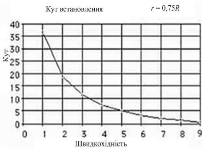
Рис. 2.38. Залежність кута встановлення лопаті від швидкохідності
