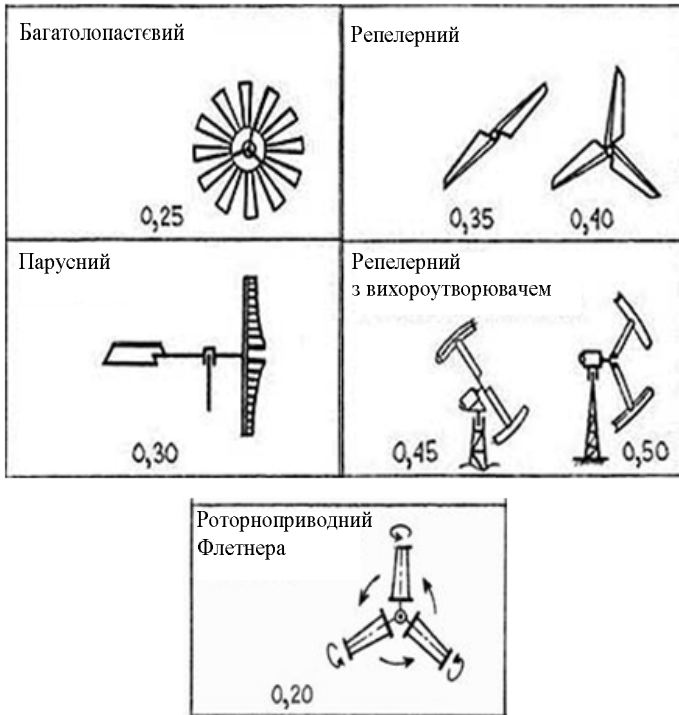
Рис. 2.13. Коефіцієнти використання вітру для горизонтально-осьових ВЕУ
