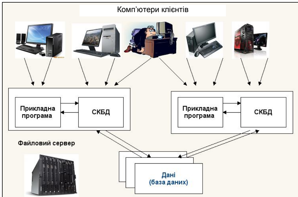
Рис. 10.11. Схема обробки інформації в БД за архітектурою "файл – сервер"
