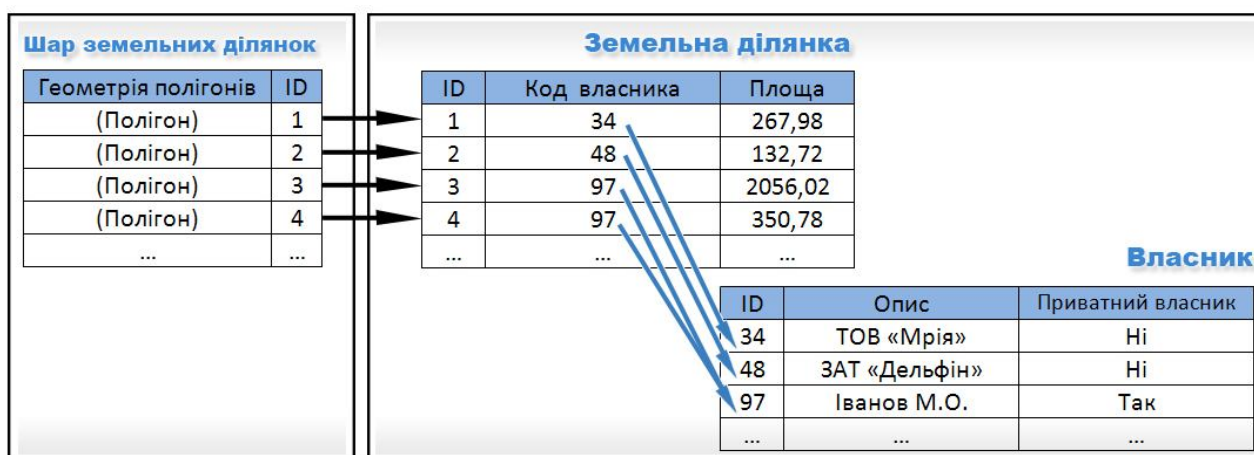
Рис. 8.42. Геореляційна база даних (ліворуч – упорядкований список просторових об'єктів у шарі карти, а праворуч – пов'язані з ними записи в базі даних)
