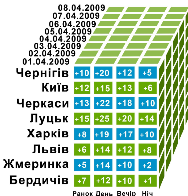
Рис. 11.18. Приклад багатомірної моделі даних
