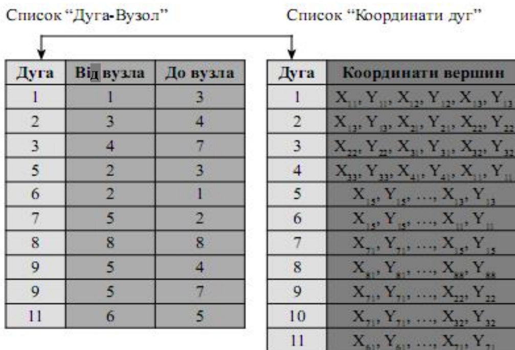
Рис. 8.34. Список "Дуга-Вузол" і зв'язаний з ним список "Координат дуг"
