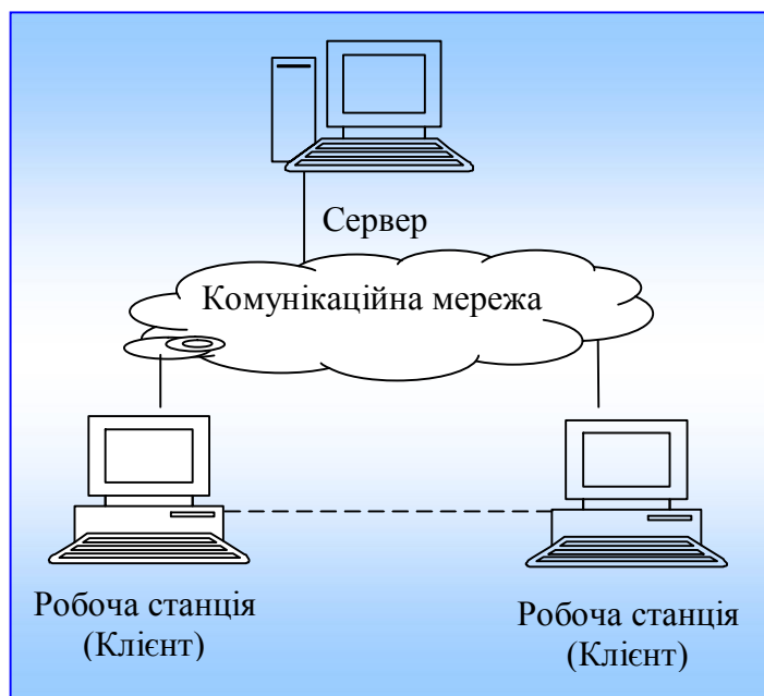
Рис. 10.13. Схема обробки інформації в БД за архітектурою "клієнт – сервер"
