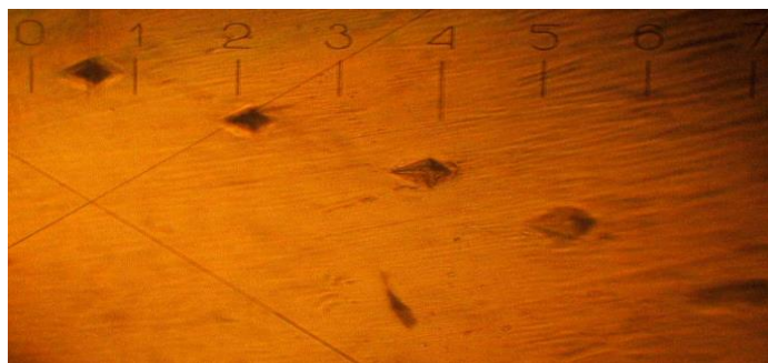
Рис. 2.11. Відбитки піраміди при визначенні лінійного зносу контактних поверхонь.
