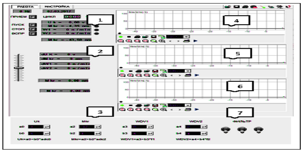
Рис. Б.4. Інтерфейс підпрограми прийому даних: 1 – прийом даних; 2 – дані після фільтрації і нормалізації; 3 – установка тарувальних коефіцієнтів; 4, 5, 6 – графічне представлення даних; 7 – управління фільтрами.
