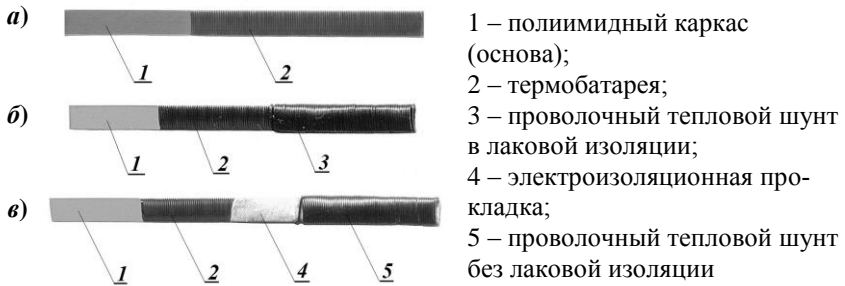
Рис. 4.28. Внешний вид термобатарейки: а – без теплового шунта; б – с тепловым шунтом в лаковой изоляции; в – с тепловым шунтом без лаковой изоляции
