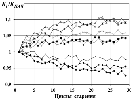
Рис.4.20. Относительные изменения коэффициентов преобразования константан-никелевых ПТП в процессе старения при термоциклировании
