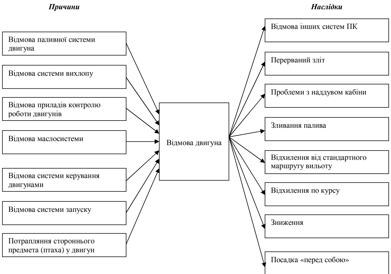
Рис. 2.1. Причини та наслідки відмови авіаційного двигуна
