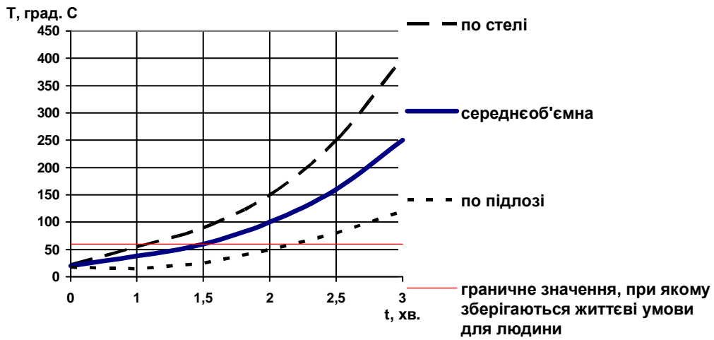
Рис. 4.16. Розподілення температури в пасажирському салоні в разі виникнення пожежі у фюзеляжі ПК
