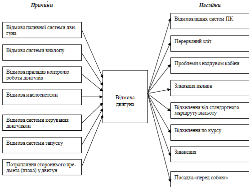
Рис. 2.5. Причини та наслідки відмови авіаційного двигуна
