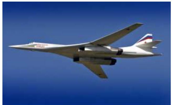
Рисунок 8.6. Самолёт Ту-160 – самый крупный в истории военной авиации сверхзвуковой самолёт и самолёт с изменяемой геометрией крыла. А так же самый тяжёлый боевой самолёт в мире, обладающий крупнейшей среди бомбардировщиков максимальной взлётной массой. Среди пилотов получил прозвище «Белый лебедь»
