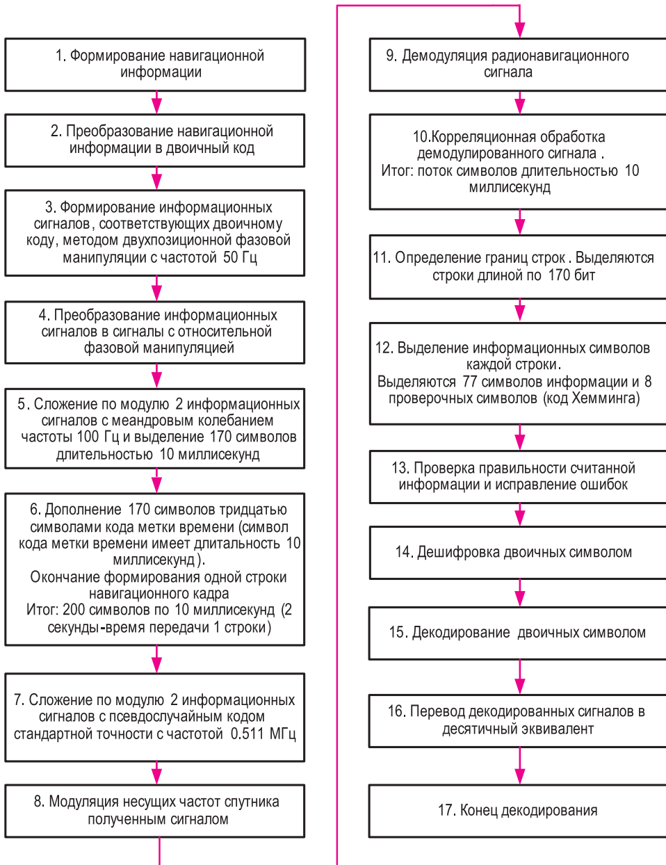
Рис. 6.37. Формирование и декодирование радионавигационного сигнала
