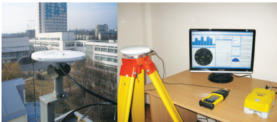
Рис. 5.60. Оборудование геодезического комплекса Trimble 5700
