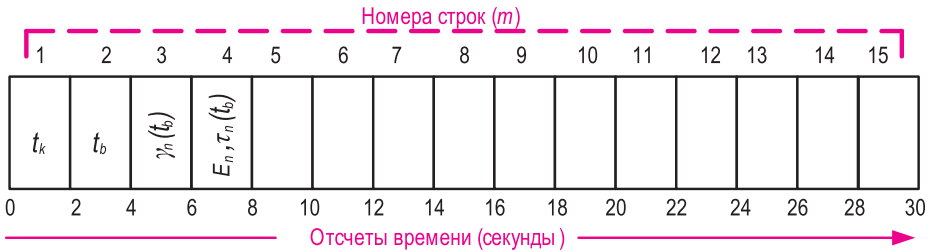
Рис. 4.20. Шкала времени навигационного спутника
