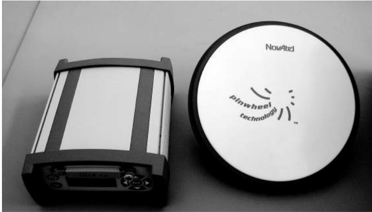
Рис. 5.61. Спутниковая навигационная станция DL-4 plus (рисунок в многоцветном воспроизведении - см. приложение, стр. 501)
