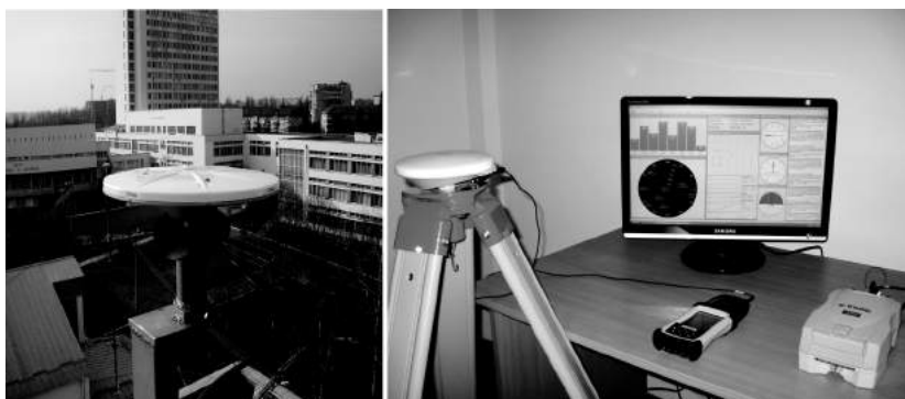
Рис. 5.60. Оборудование геодезического комплекса Trimble 5700 (рисунок в многоцветном воспроизведении - см. приложение, стр. 501)
