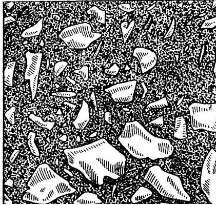
Рис. 9.1. Структура асфальтового бетону (зріз)
